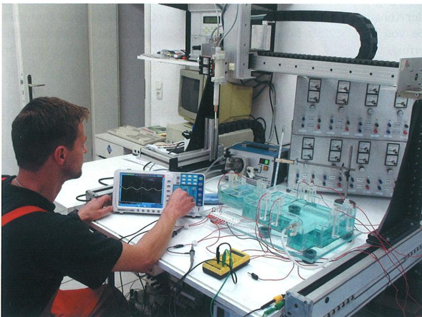
Untersuchungen zur Findung der passenden Dimensionierung und Positionierung der Erdelektrode
